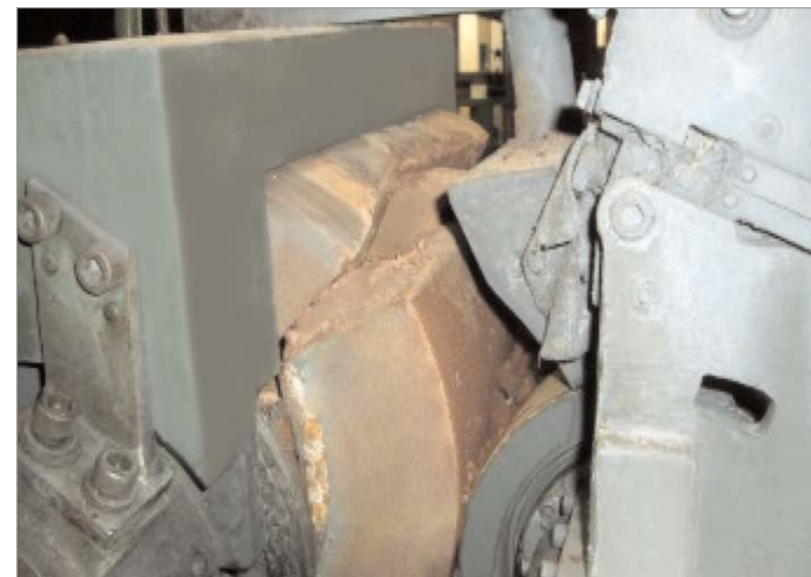
Flange deformate causano la rottura della mola
